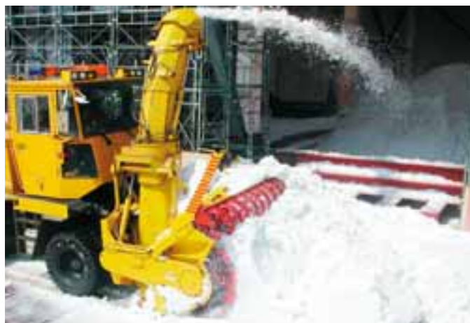
2008年北海道洞爷湖峰会国际媒体中心 往雪室搬雪的状况 2008年北海道洞爺湖サミット国際メディアセンター 雪室への雪搬入状況
