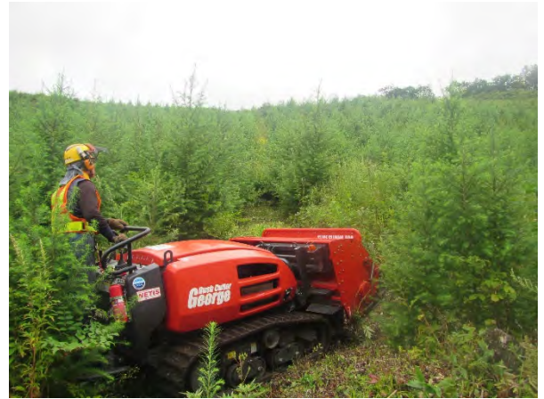
乗用型下刈り機械による作業
