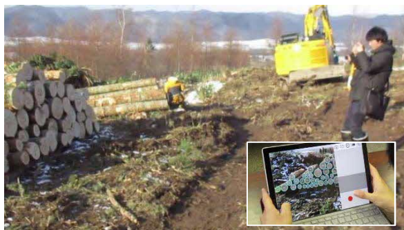
【図 3-2】 林業成長産業化地域創出モデル事業での丸太写真検知実証（網走西部流域）
