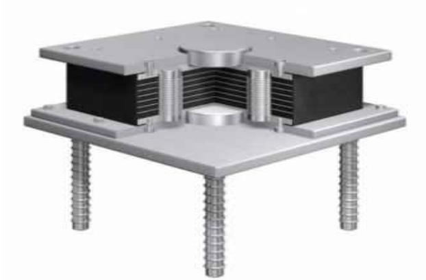
スプリング拘束型鉛プラグ入り積層ゴム支承 (SPR)
