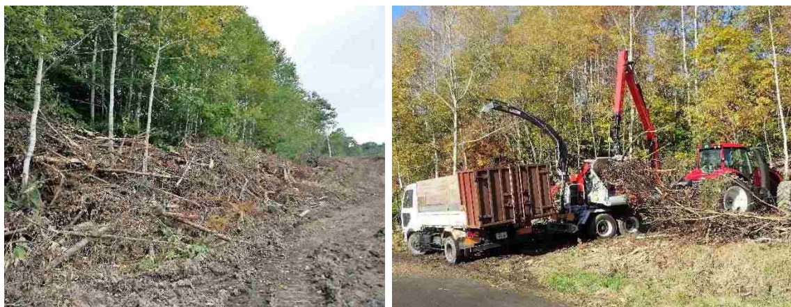
写真 3.8 未利用材堆積とトラクター牽引式チップパー機による木くず化
