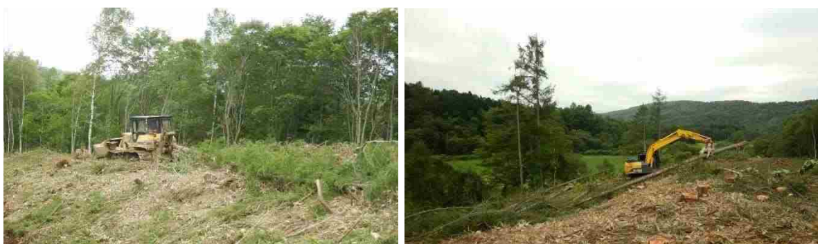
写真 3.6 ブルドーザー全木集材からグラップル集材の試行
