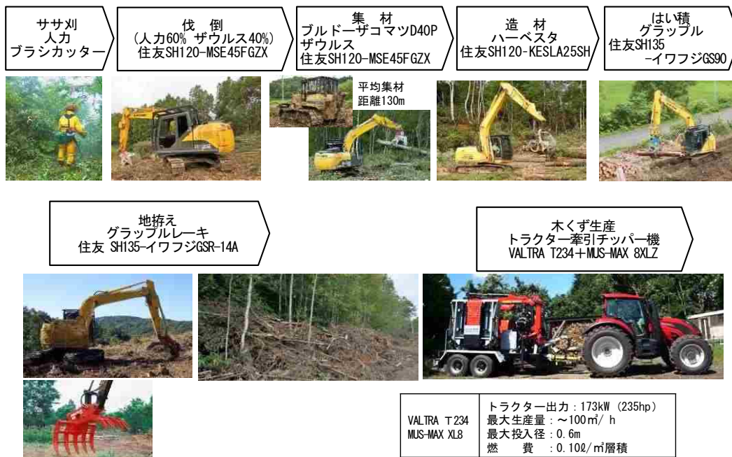
図 3.4 道北地区（中頓別町）における作業システム
