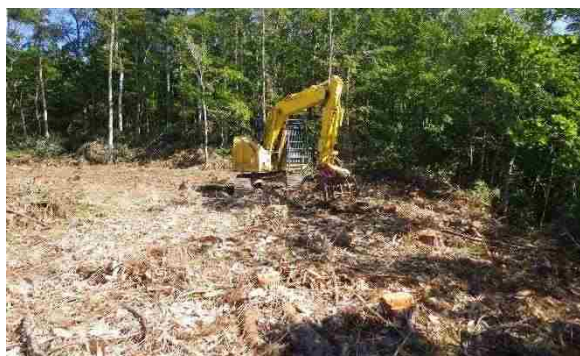
写真 3.7 グラップル用大型レーキによる地拵え
