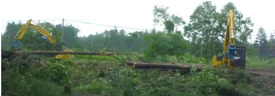
写真 3-13 グラップルによる順送り様式の効率良い集材
