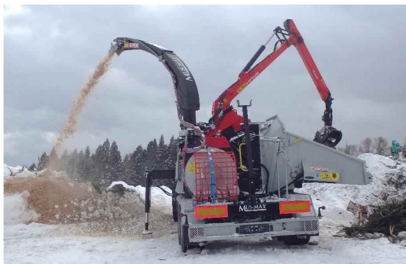
写真 3-24 トラクタ PTO 駆動牽引式チップパー機
