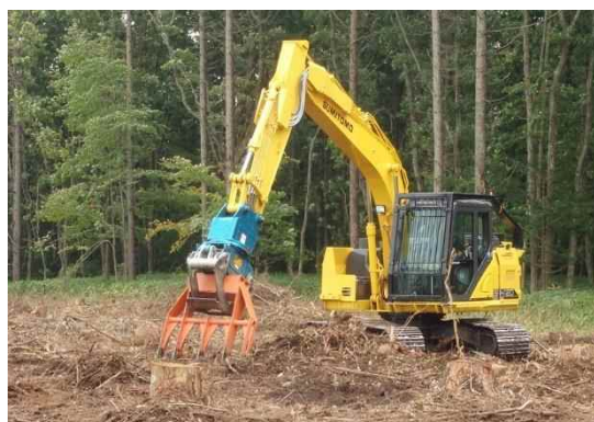
写真 3-14 グラップル大型レーキによる地拵え
