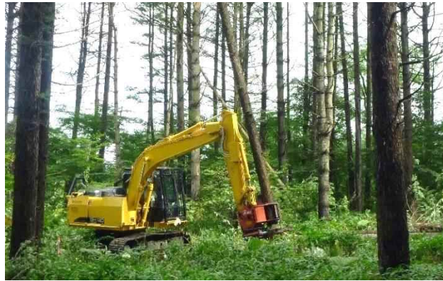
写真 3-12 フェラバンチャの伐木状況
