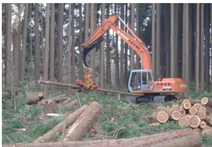
写真 3-20 ハーベスタによる径級別に小分け集積
