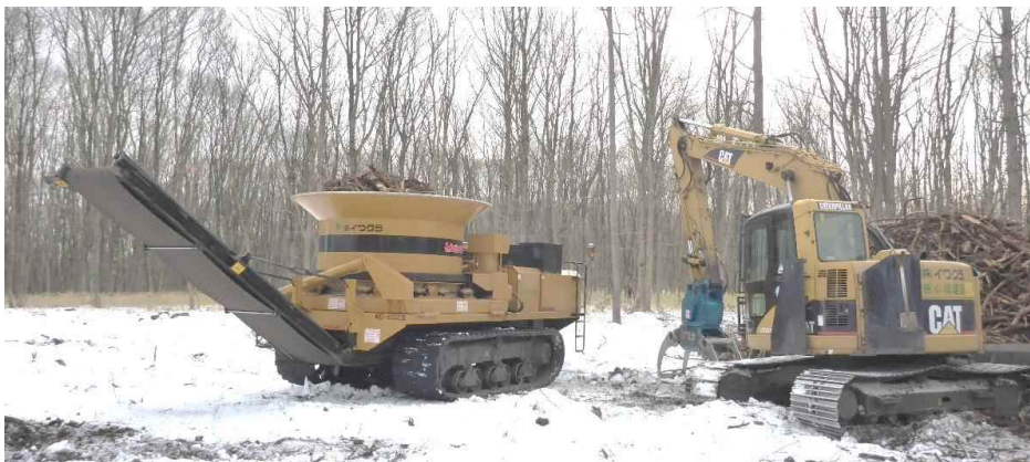
写真 3-16 クローラ形式チップパー機とグラップルセット
