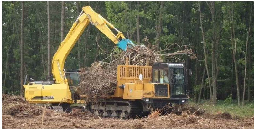
写真 3-15 広葉樹枝条のグラップルとフォワーダを使用した枝条集荷
