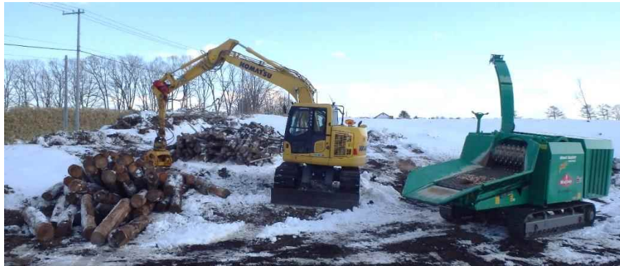
写真 3-7 クローラ形式チップパー機とグラップルセット
