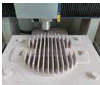
【モデリングマシンによる鋳造型製作】
