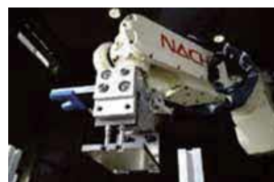
【ロボットによる搬送位置決め】
