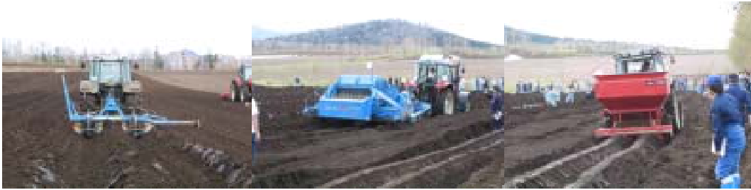
ソイルコンディショニングシステムによる一連の作業 (左から、土寄せ(ベッドフォーマ)、石塊や土塊の除去 (セパレータ)、播種床をつくり植付け(深植えプランタ))
