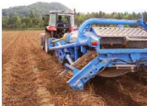
掘取り作業(ハーベスタ。いもは横のうね間に置いていく)
