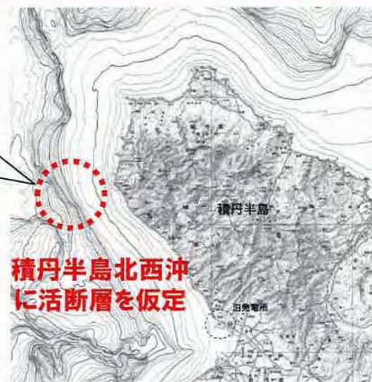
※2 地震動評価においては、上記位置に長さ約22.6kmの断層を設定することで検討中。
