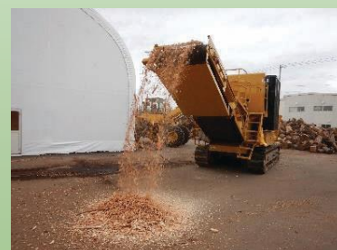
発電所敷地内で チップ加工
