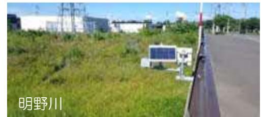
危機管理型水位計による観測データの提供 (胆振総合振興局)
