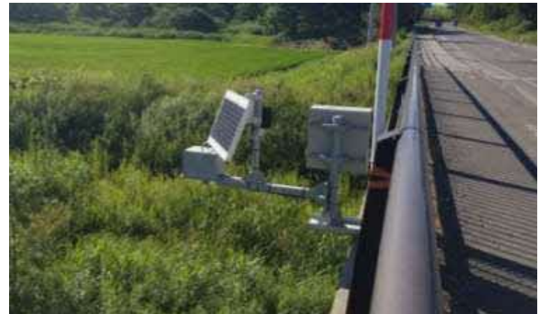
(ニタッポロ川) 危機管理型水位計による観測データの提供
