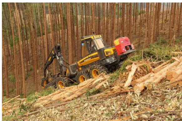
ケーブルアシストにより急傾斜で伐倒作業を行う
