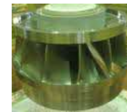
高効率水車への取り換え
