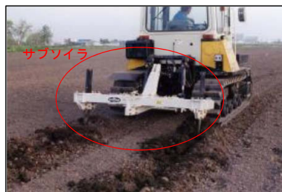
写真3 サブソイラによる心土破碎の施工の様子
