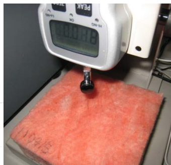
繊維系断熱材の耐久性評価 突き刺し試験法の開発
