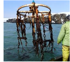
SKフープ方式による雑海藻駆除の様子 チェーンのついた円盤を船上から海底に入れ、油圧で回転させ雑海藻を削り取る。
