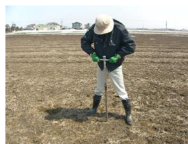
写真-3 ジピリジル調査 (検土杖による土壌採取)
