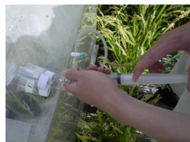
写真-1 水田のメタンガス採取
