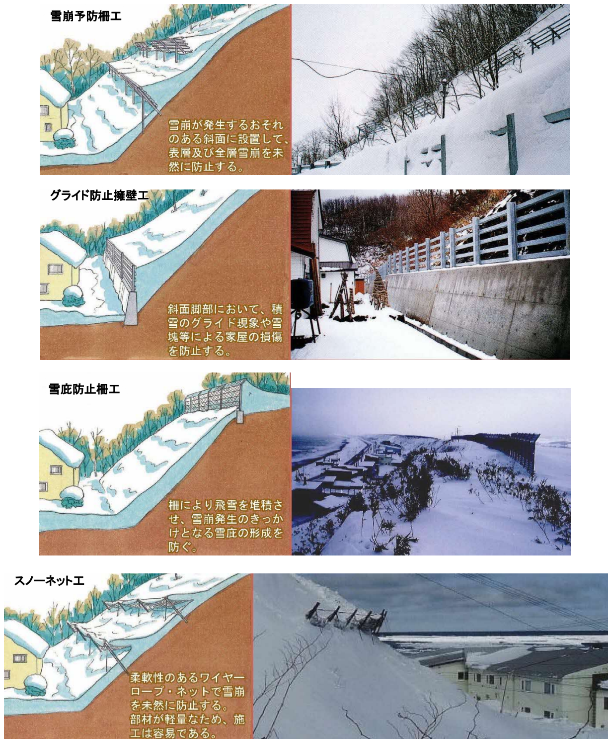
図 2-5 北海道が管理する雪崩防止施設
