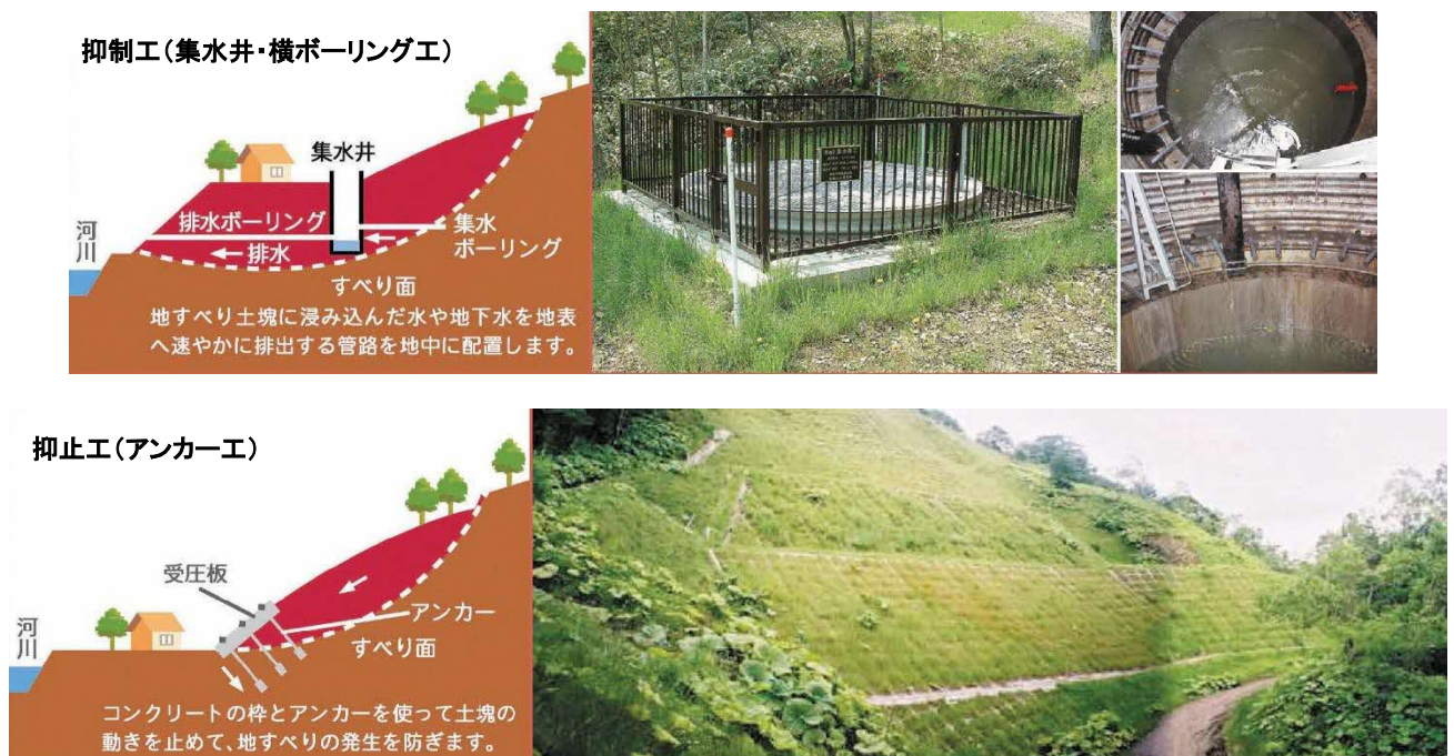
図 2-3 北海道が管理する地すべり防止施設
