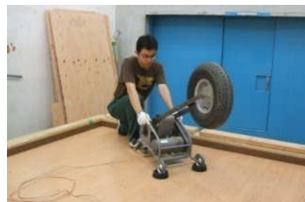
床衝撃音測定状況（バングマシン）
