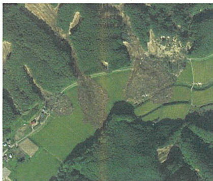
山腹崩壊による農地への土砂堆積
