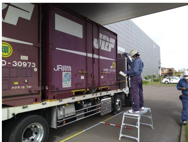
写真3：運搬車両の空間線量率測定状況
