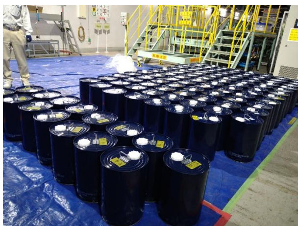
写真1：処理後物（廃アルカリ）の保管状況
