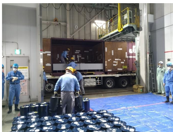
写真2：処理後物（廃アルカリ）の払出作業
