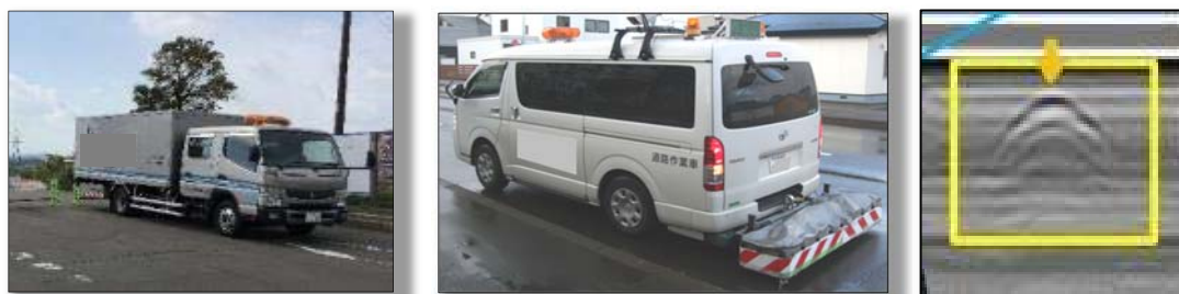
写真 2-1 一次調査の探査車と異常信号の例
