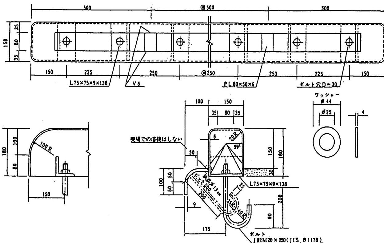
図5-2 車止めの標準寸法
