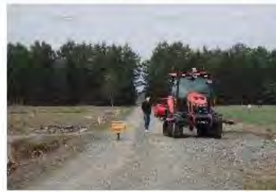
農道にある障害物を遠隔操縦で回避するロボットトラクター
