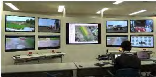
遠隔監視センターにおける複数台のスマート農機の遠隔監視・制御
