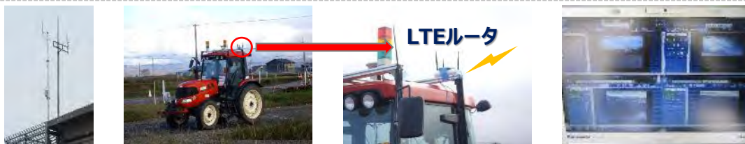
地域BWA 地域BWAを活用した監視映像伝送の実証 LTEルータ 検証時のモニタPC画面
