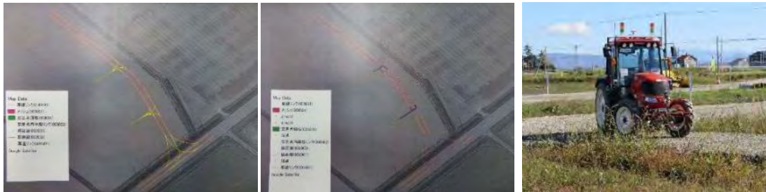
MMS測量による走行ライン（加工前） MMS測量による走行ライン（加工後） 走行ラインに基づき無人で走行するトラクター
