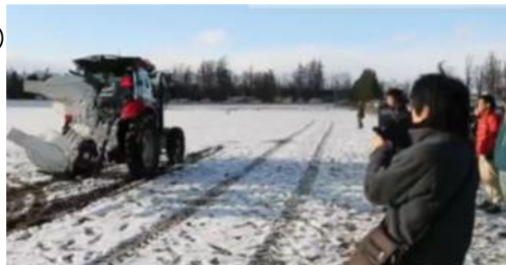
無人の状態では後ろのプラウが反転し耕起作業する
