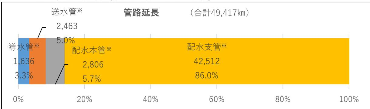
※ 導水管：原水を浄水場へ送るための管
