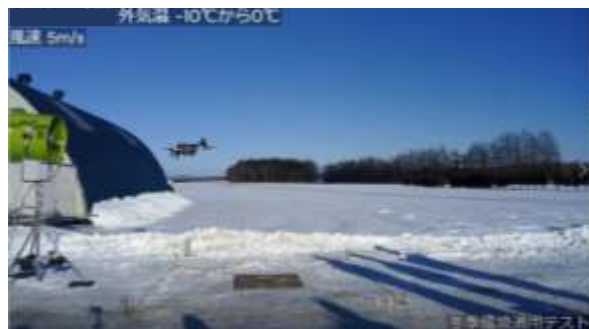
零下、風速5m/s下で飛行するドローン
