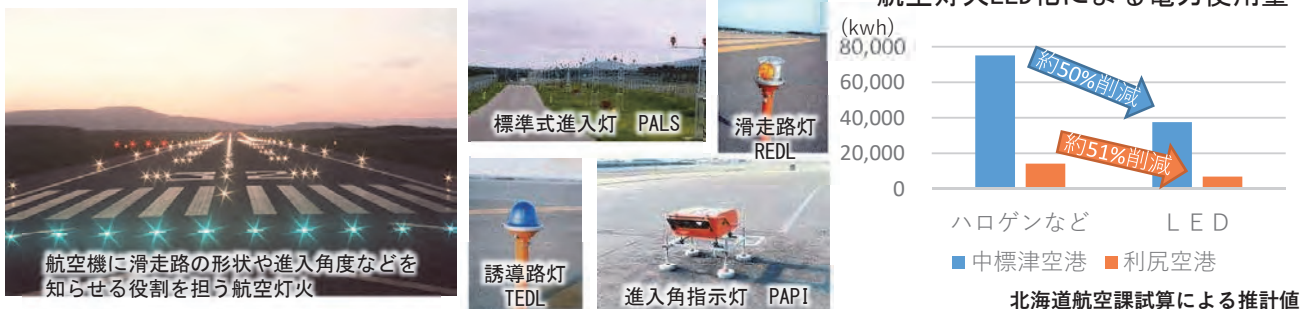
航空灯火LED化による電力使用量
