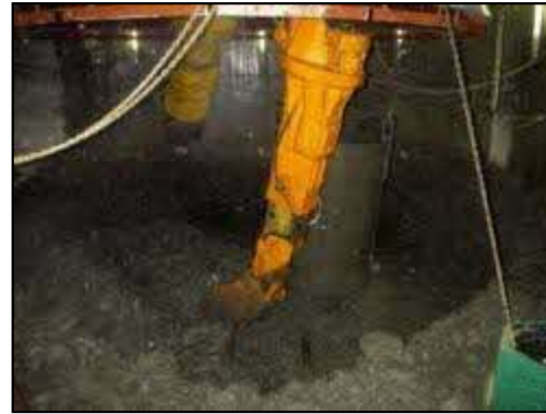
換気立坑積込機製作
