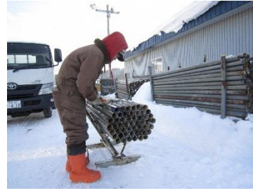
写真F 六角形の形に整ったらまとめる (「1 単位=単管 51 本」が完成)
