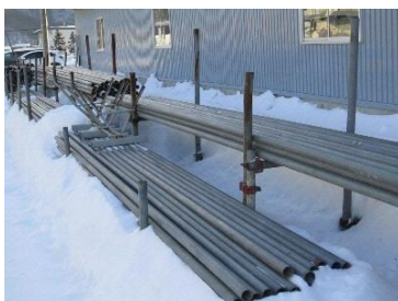
写真 A 機材センターに置かれた単管
