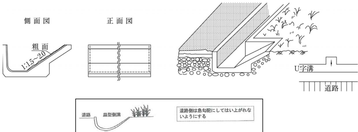
図-7.7.1 小動物に配慮した側溝の例 (1)
