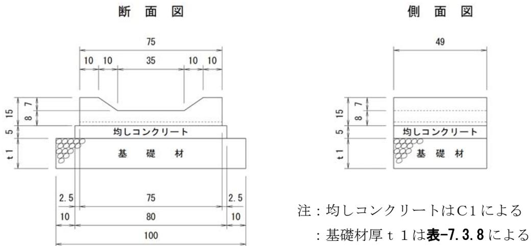
図-7.3.4 皿型側溝の標準図
