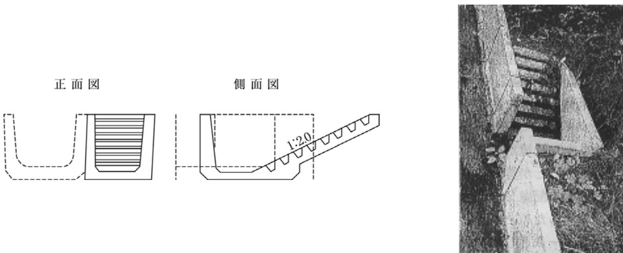
図-7.7.2 小動物に配慮した側溝の例 (2)
