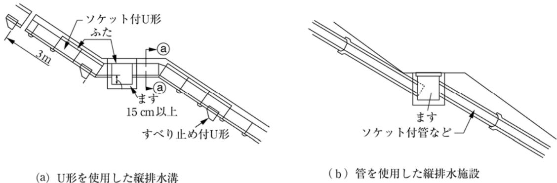
図-7.5.6 縦排水溝断面図
