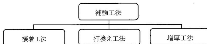
図-8.4.3 補強工法の分類
