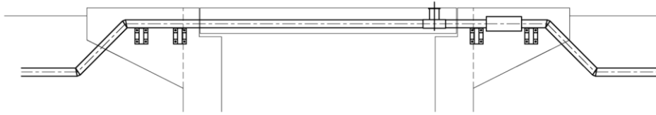
図-2.9.8 パイプビーム方式の形状
