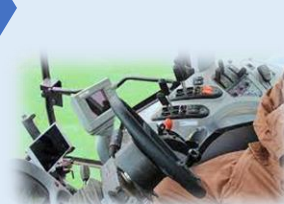
ガイダンス画面をみながらトラクターの自動操舵作業での耕起
