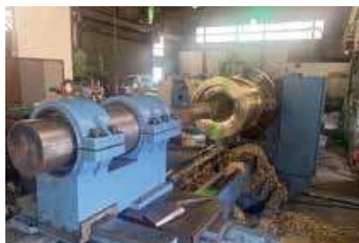
▲圧下スクリューナット 鋸刃2条ネジ加工
