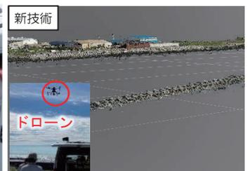
ドローンでの3次元測量を活用し、3次元の点群データによる点検
