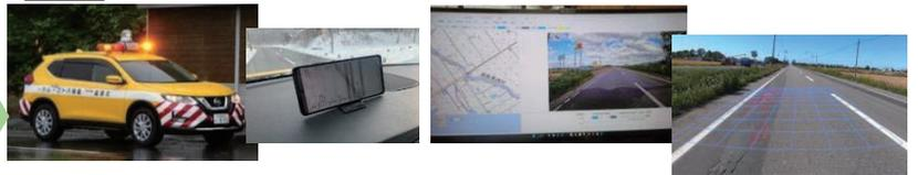
▲パトロール車両に設置したスマートフォンの加速度計を用いて平坦性を算出
