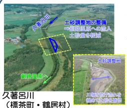
釧路湿原の乾燥化の一因 である河川からの土砂流 入を軽減させるため、土 砂調整地を整備
